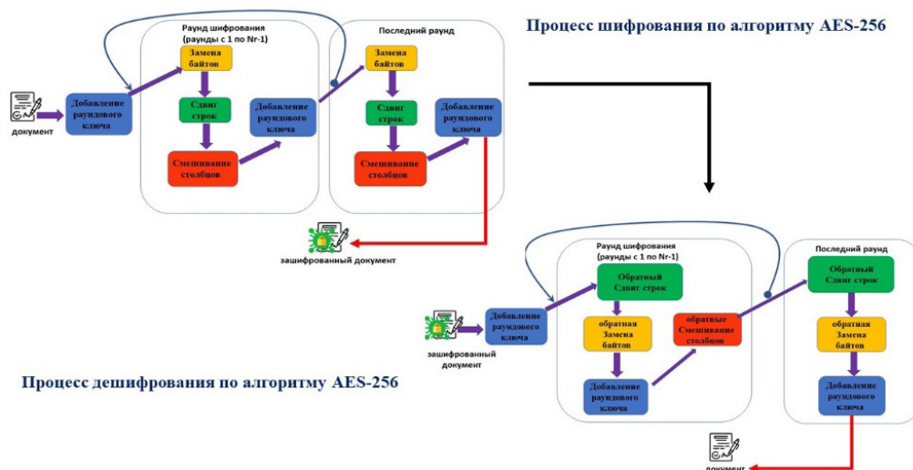
Рис. 2. Порядок шифрования и дешифрования AES-256
