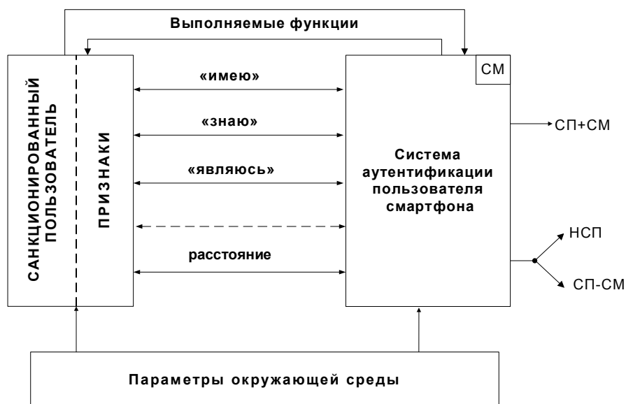
Рис. 1. Схема процесса аутентификации пользователя смартфона
