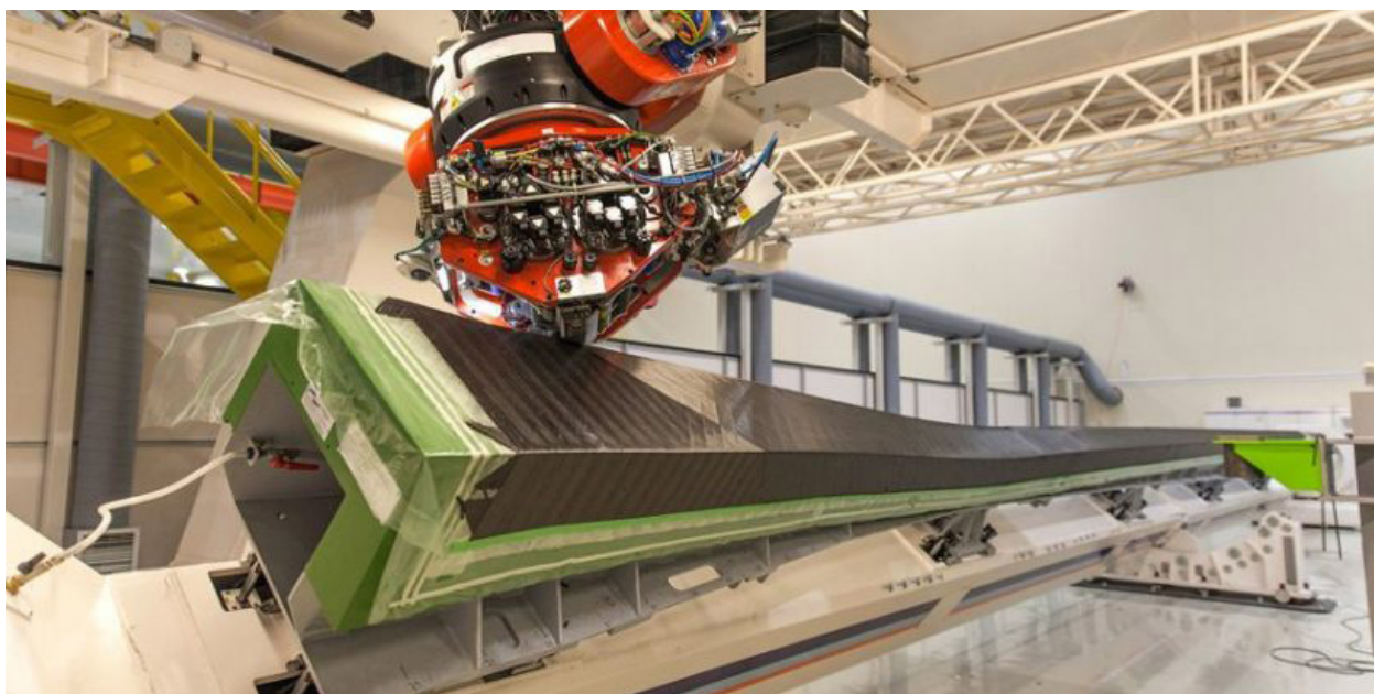
Рис. 6. Автоматизированная выкладка углеволокна на оснастку на примере производства лонжерона крыла самолета МС-21 [9]
