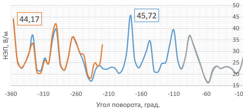
Рис. 4. Результаты определения максимума изотропной НЭП в РЭК РЕВЕР 1000 при нескольких полных поворотах тюнера на частоте 1200 МГц
