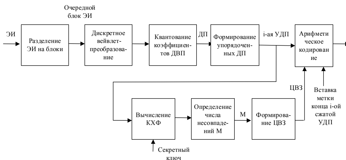
Рис. 4. Структурная схема формирования аутентифицированного электронного изображения в соответствии с патентом RU 2589849
