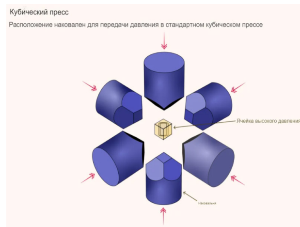
Рис. 4. Схема многопуансонного аппарата высокого давления [8]
