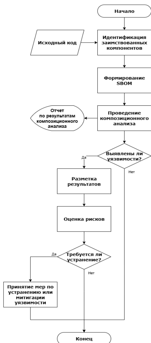
Рис. 1. Обобщенный алгоритм композиционного анализа заимствованных компонентов
