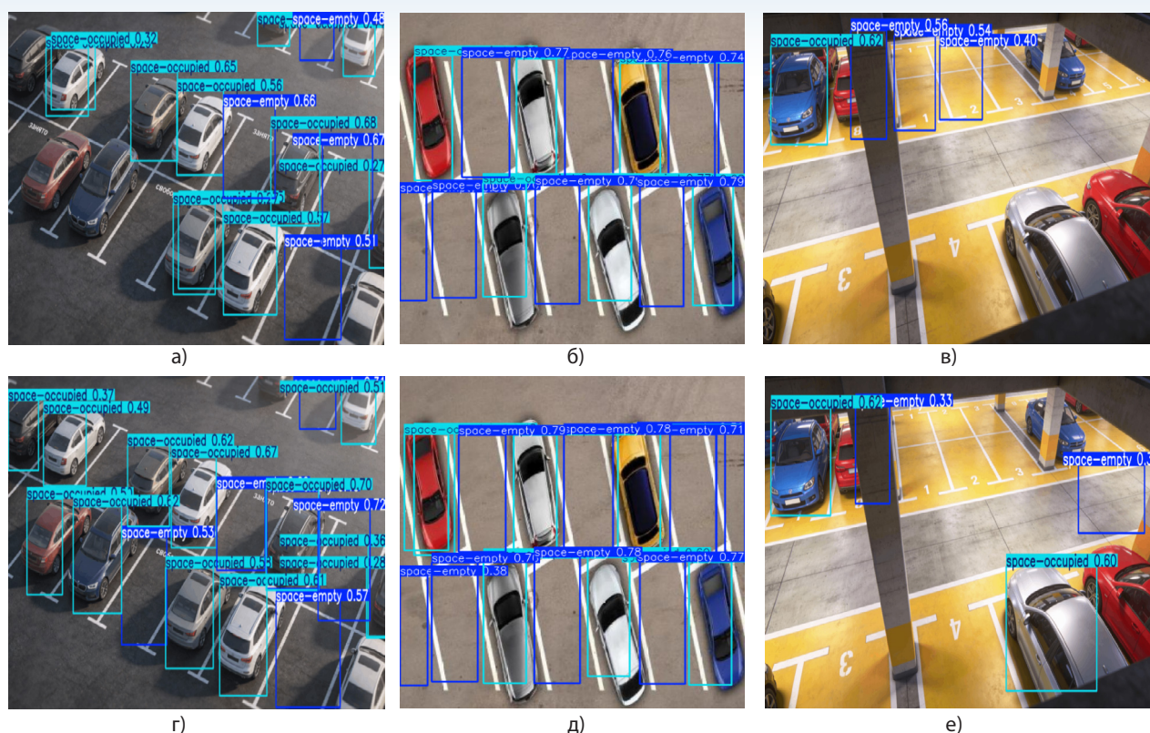
Рис. 12. Тестирование моделей на синтетическом наборе: YOLOv11 (а-в); YOLOv12 (г-е)
